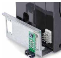
**E1** Interfaccia MH455 con connettore 10 PIN.
