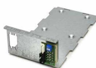
**F1** Interfaccia MH583 con connettore 10 PIN.
